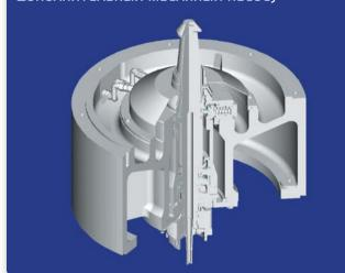
тия разгрузочных полостей устанавливается и отслеживается при помощи программируемого логического контроллера, расположенного на панели управления сепаратора.
