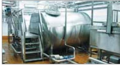
свести к минимуму время отбора сыворотки и не допустить комкование сырной массы. Система подготовки теплоносителя позволяет регулировать его температуру и продолжительность второго нагревания с учетом необходимой степени обезвоживания сырной массы и интенсивности развития молочнокислого процесса; исключить заваривание сырного зерна и предотвратить получение грубой, крошливой консистенции. Готовое сырное зерно с сывороткой роторным насосом OptiLob бережно подается в формовочный аппарат.
