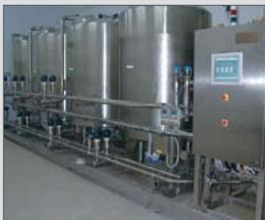
CIP-мойка REDA, установленная на ОАО «Лянозовский МК», цех производства JOY FIT
